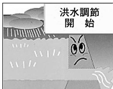
**2** ダムへ入ってくる水量がどんどん増えて毎秒2,100㎡以上になったとき、洪水調節を開始します。増えた水量を一時的にダムに貯め、放流量を抑えることで洪水調節します。
