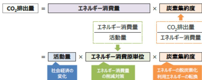
図 7-2 CO<sub>2</sub> 排出量の推計式
