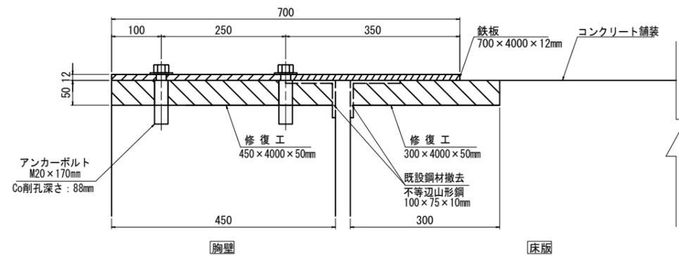
※アンカーボルトはナット締付け後、突出しているネジ部分を切断撤去すること。
